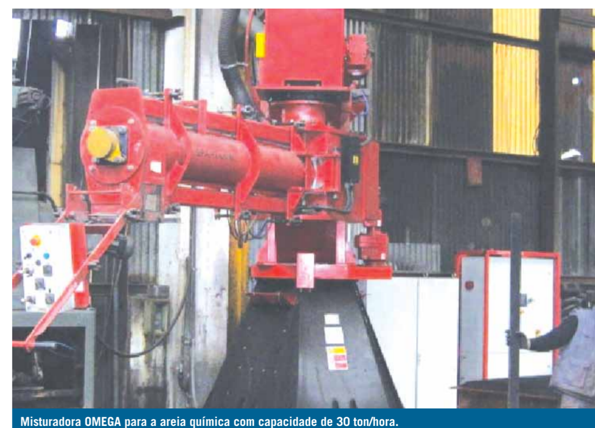
Misturadora OMEGA para a areia química com capacidade de 30 ton/hora.
